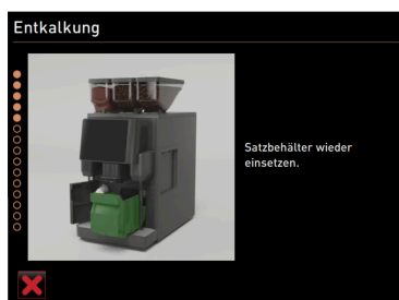
Afbeelding: Droesbak plaatsen
