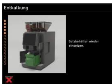
Afbeelding: Droesbak plaatsen
